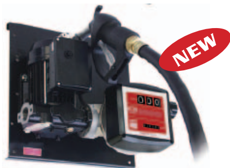
Stazione murale di travaso gasolio con pompa autodescendente volumetrica 220 V, contatore meccanico, pistola in alluminio; 5 M tubo mandata antistatico Wall dispensing diesel oil transfer unit with volumetric vanes pump 220 V, mechanical flow meter, aluminium manual nozzle, 5 M (16,40 ft) antistatic discharging hose.
